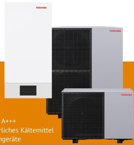
R290 Luft/Wasser Wärmepumpen im BiBloc-Design für Vorlauf-Temperaturen bis +70°C, im Leistungsbereich von 4 bis 16 kW, zur Bereitung von Warm- oder Kaltwasser. Kombination von Außengerät und Hydrobox zur Versorgung aller Anwendungen wie Warmwasserspeicher, Fancoils, Radiatoren oder Fußbodenheizung.
